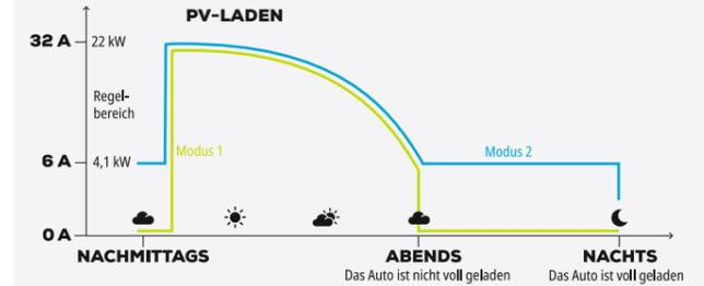
**MODUS 1** Reines Überschussladen. Es wird der ALPHA XT ausschließlich Strom aus der PV-Anlage zugeführt. Bei weniger als 6 A aus der PV-Anlage wird das Laden von Autos abgeschaltet. Ein Wiedereinschalten wird versucht, muss aber vom Fahrzeug unterstützt werden.
